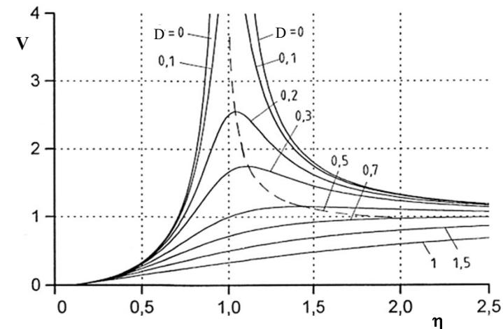
Der Phasenwinkel der Massenkraftanregung entspricht dem der Fußpunktanregung. Für  $\eta < 1$  schwingt das System gleichphasig mit der Anregung, für  $\eta > 1$  gegenphasig.
