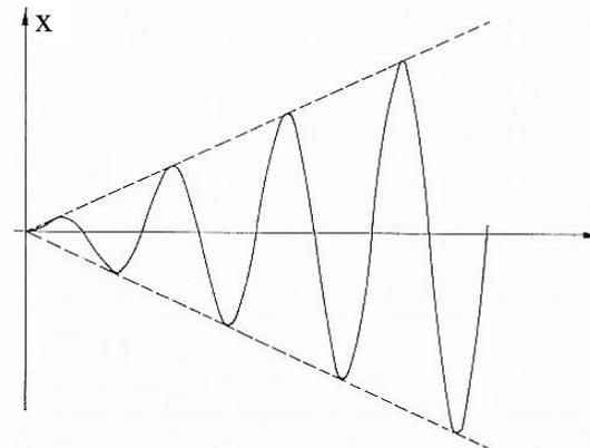
Im Resonanzfall  $\Omega = \omega_0$  strebt der Vergrößerungsfaktor  $\eta$  gegen unendlich, die Schwingungsamplituden steigen linear mit der Zeit an.
