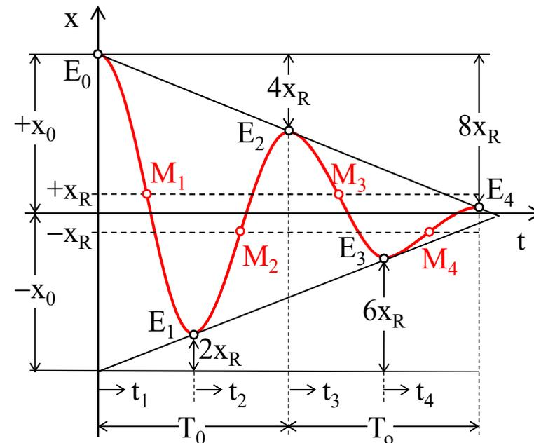
Bei jeder Bewegungsumkehr kommt der Schwinger kurzzeitig zur Ruhe. Für die weitere Bewegung muss die Restfederkraft
