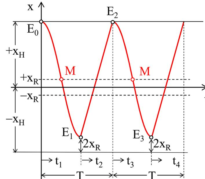
Der Stick-Slip-Effekt ist in technischen Anwendungen meist unerwünscht. Er erzeugt Lärm und Körperschall und führt zu erhöhtem Verschleiß und Materialermüdung. Er kann durch ausreichende Schmierung vermieden werden.
