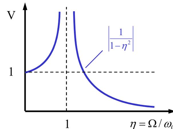
Für  $\eta < 1$  folgt das System gleichphasig der Bewegung des Fußpunktes. Bei  $\eta = 1$  werden die Ausschläge unendlich, es liegt Resonanz vor. Für  $\eta > 1$  schwingt das System gegenphasig. Für große Werte von  $\eta$  ist das System zu träge, um der Fußpunkterregung zu folgen.
