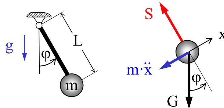
Für kleine Winkel gilt jedoch  $\sin\varphi \approx \varphi$  und man erhält damit die linearisierte Differentialgleichung der Pendelschwingung
