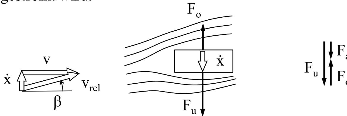
Durch die schräge Anströmung entstehen unterschiedliche Druckverteilungen auf der Ober- und Unterseite, was beim Rechteck zu einer resultierenden Anfachkraft  $F_a$  führt, die in Richtung der Querbewegung zeigt, d.h. die Bewegung wird in der Störungsrichtung verstärkt. Bei der Rückwärtsbewegung ergeben sich analoge Verhältnisse, es entsteht eine angefachte Schwingung mit niedriger Frequenz und großer Amplitude.
