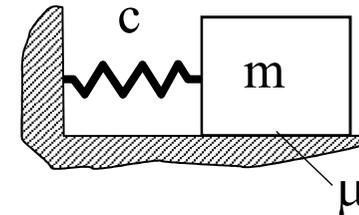
Wird das Feder-Masse-System ausgelenkt und losgelassen, verhält sich die Reibkraft bereichsweise linear, je nach Bewegungsrichtung ergeben sich jedoch unterschiedliche Schwingungsgleichungen. Für die Hinbewegung ( $\dot{x} > 0$ ) folgt
