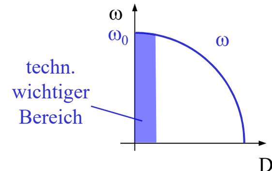
Für den technisch wichtigen Fall sehr schwacher Dämpfung ( $D < 0,1$ ) stimmt  $\omega$  und  $\omega_0$  praktisch überein. Die Periodendauer des gedämpften Systems ergibt sich aus
