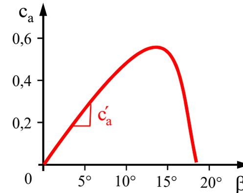
Für kleine Anstellwinkel kann der Abtriebsbeiwert näherungsweise durch eine Gerade beschrieben werden. Mit der Steigung  $c'_a$  und  $\tan \beta \approx \beta = \dot{x}/v$  folgt
