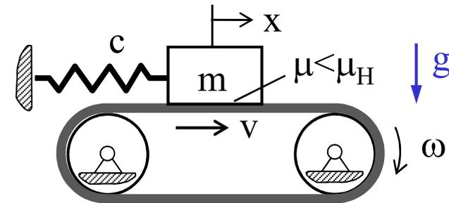
Zunächst haftet der Körper auf dem Band und wird von diesem mitgenommen. Die Feder dehnt sich, bis die Federkraft die Haftkraft übersteigt. Die Masse gleitet ab und bewegt sich in Gegenrichtung. Dadurch wird die Feder entspannt. Aufgrund ihrer Trägheit bewegt sich die Masse ein Stück über den Punkt hinaus, an dem die Federkraft gleich der Reibkraft ist, und kommt dann zur Ruhe. Der Körper haftet und wird wieder vom Band mitgenommen, der Vorgang wiederholt sich.
