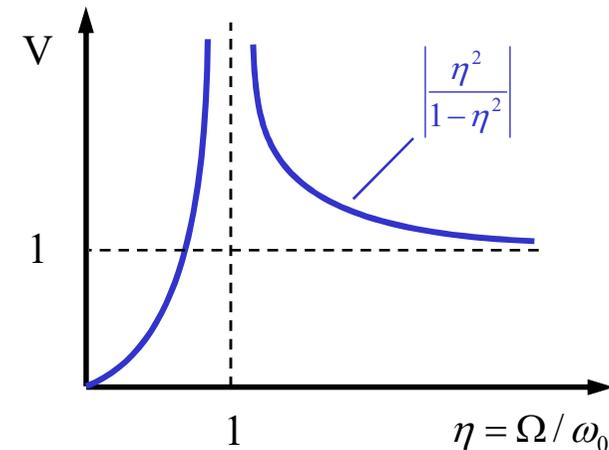
Für  $\eta < 1$  ist die Auslenkung infolge der geringen Winkelgeschwindigkeit klein. Bei  $\eta = 1$  liegt Resonanz vor. Für  $\eta > 1$  folgt die Auslenkung der Masse gegenphasig zur Auslenkung der Unwucht.
