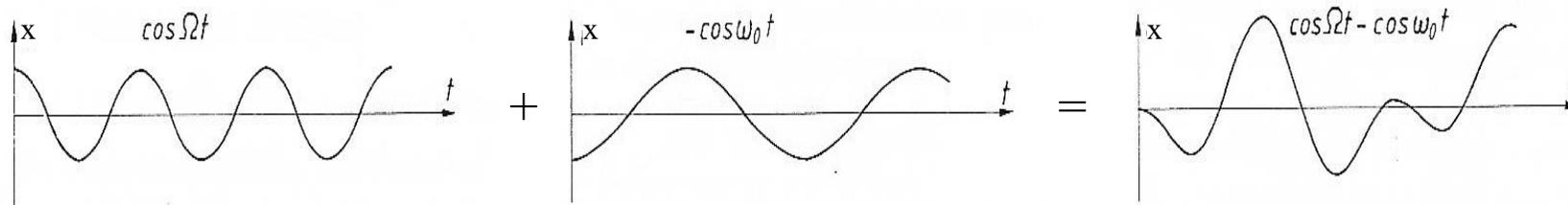
Liegt die Erregerfrequenz  $\Omega$  nahe der Eigenfrequenz  $\omega_0$ , kommt es zur sog. Schwebung.
