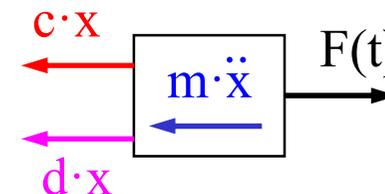
Hingegen bleibt der partikuläre Anteil als stationäre Schwingung erhalten. Da es infolge der Dämpfung zu einer Phasenverschiebung zwischen Erregung und erzwungener Schwingung kommt, muss dies in der Lösung des partikulären Anteils durch den Ansatz der rechten Seite berücksichtigt werden.
