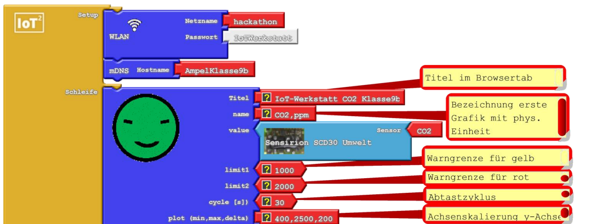
Fig. 3: Mit Verwendung des mDNS-Blocks im Setup ist der Server im lokalen Netz per Namen erreichbar.
