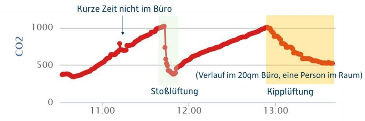
Fig. 6: Die örtlichen Gegebenheiten bestimmen die Lüftungsdauer. Je nach Situation kann es mehrere Minuten dauern, bis ein stationärer Wert erreicht wird. Nur bei Querlüftung wird die komplette Raumluft ausgetauscht und der Sensor sieht Frischluft. Dies ist besonders bei der Kalibrierung vor Ort wichtig.
