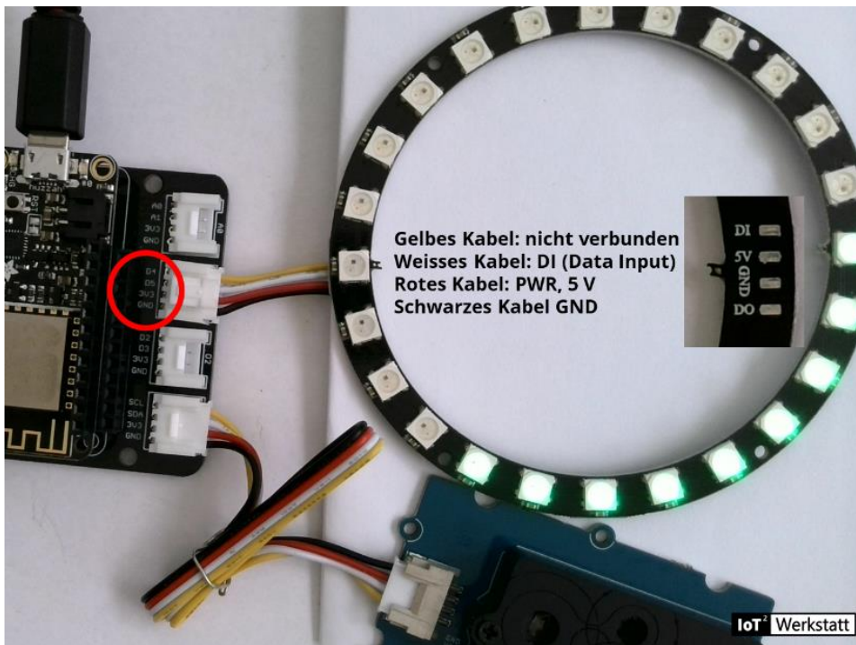
Abb 4: NeoPixel-Ring mit 24 Pixeln
