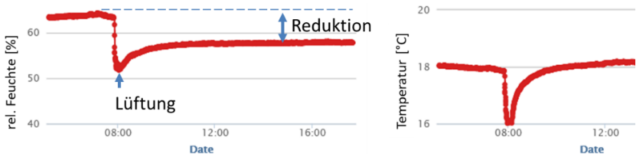
Abb. 52: Durch Stoß-/Querlüften können wir die Feuchte reduzieren
