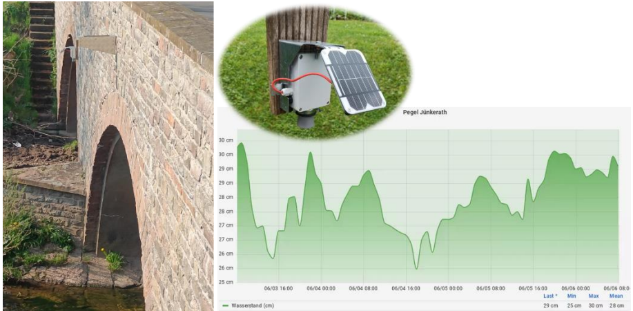
Abb. 77: Ultraschallsensor, wasserdichtes Gehäuse, Solarzelle, LoRa-Netzwerk. IoT-Gerät als Starkregenpegel an der Kyll, programmiert mit der grafischen Oberfläche der IoT 2 -Werkstatt.
