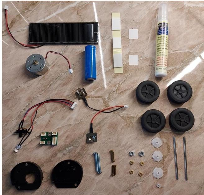
**Abb.: Bauteile des Rennwagenmodells, die nicht aus Holz bestehen**
