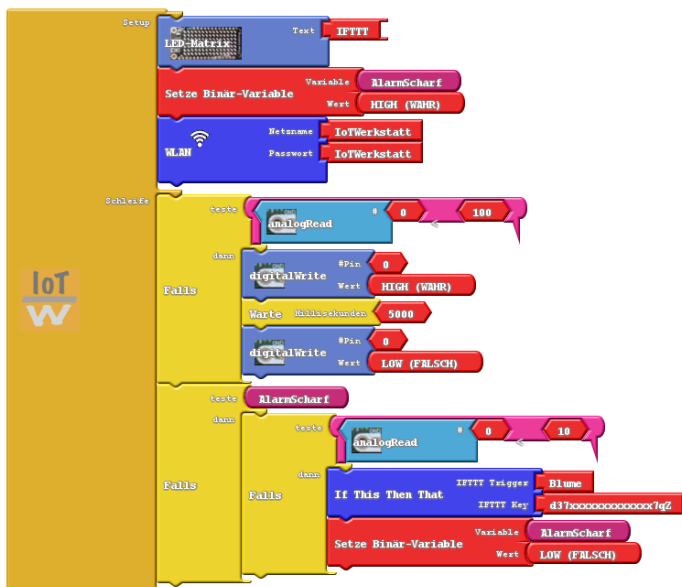
Abb. 25: Bewässerung mit Cloud-Anbindung
