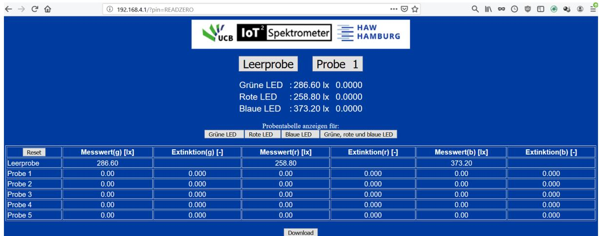
Fig. 4: Web-Oberfläche des DIY-Spektrometers
