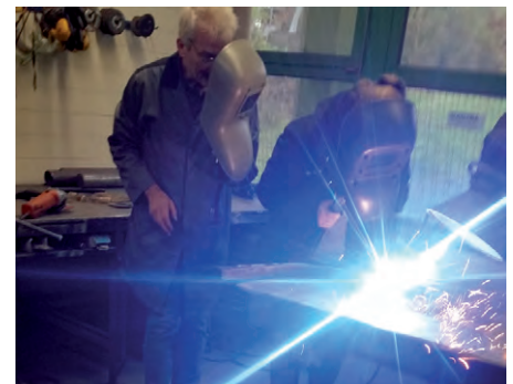
Einer der Schüler beim selbstständigen Anfertigen einer Auftragsschweißung.
