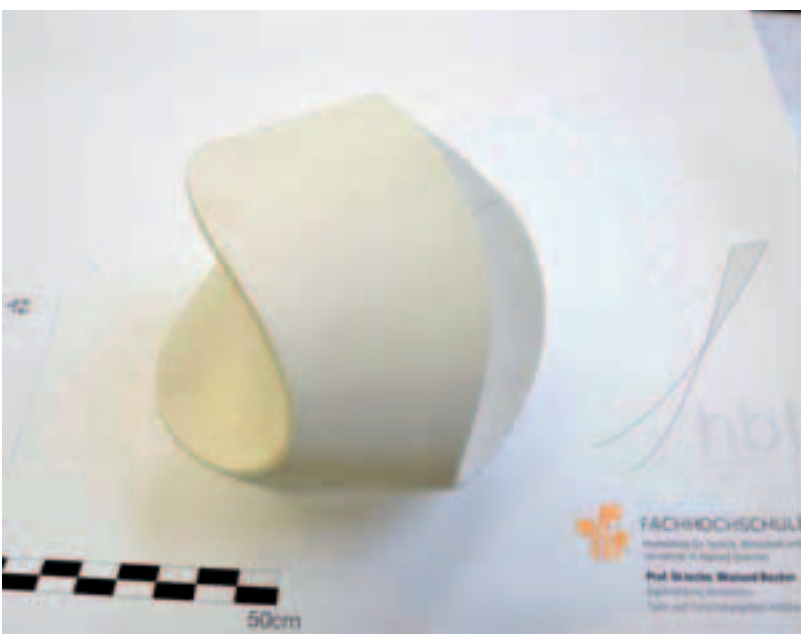
Bild 3: Urform im 3 D-Printverfahren und Umsetzung in Mineralguss
