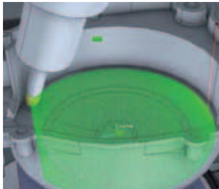
Werkzeugbahnsimulation Kopierfräsen mit angestellter Werkzeugachse
