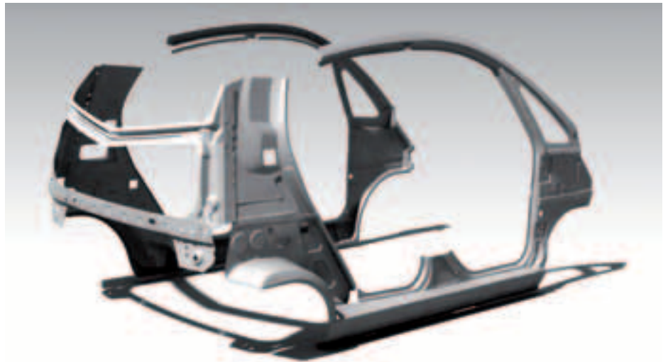
3D-Geometrie nach dem Reverse Engineering
