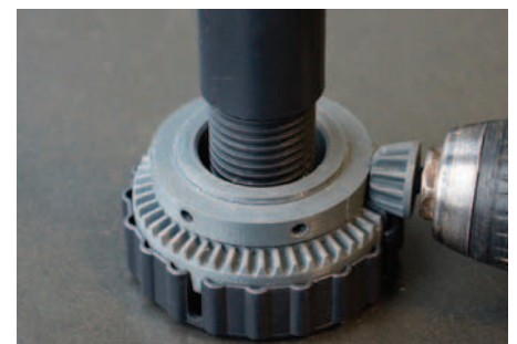
Abb. 4: Funktionsprototyp aus dem 3D-Druck: Winkelsteller zur Höhenverstellung von Möbelfüßen
