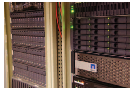
Plattenspeicher-Technologie im Wandel: links 34TB (2009) und rechts 118TB (2015)
