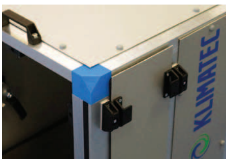
Abb. 3: Prototyp des Eckverbinders aus dem 3D-Druck im Funktionstest
