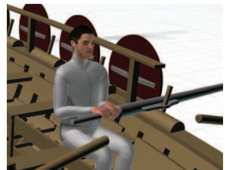
Ergonomie-Untersuchung mit einem virtuellen Menschmodell.
